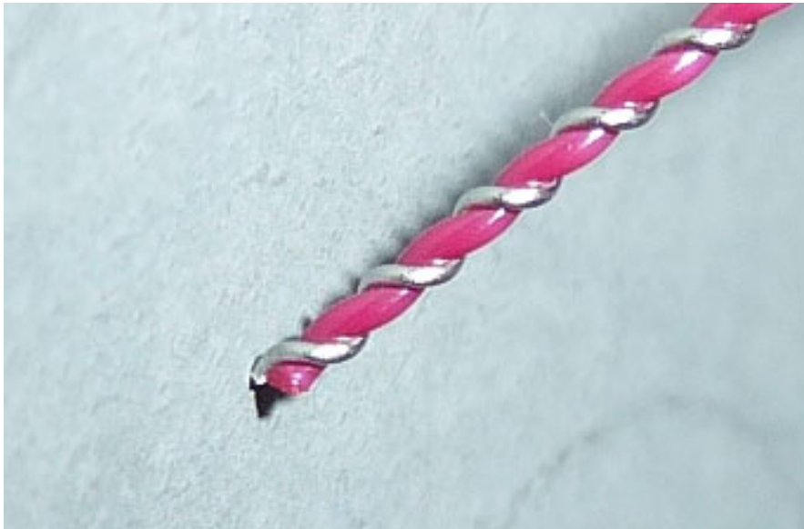
④写真 査察用封印の断面部の状況
